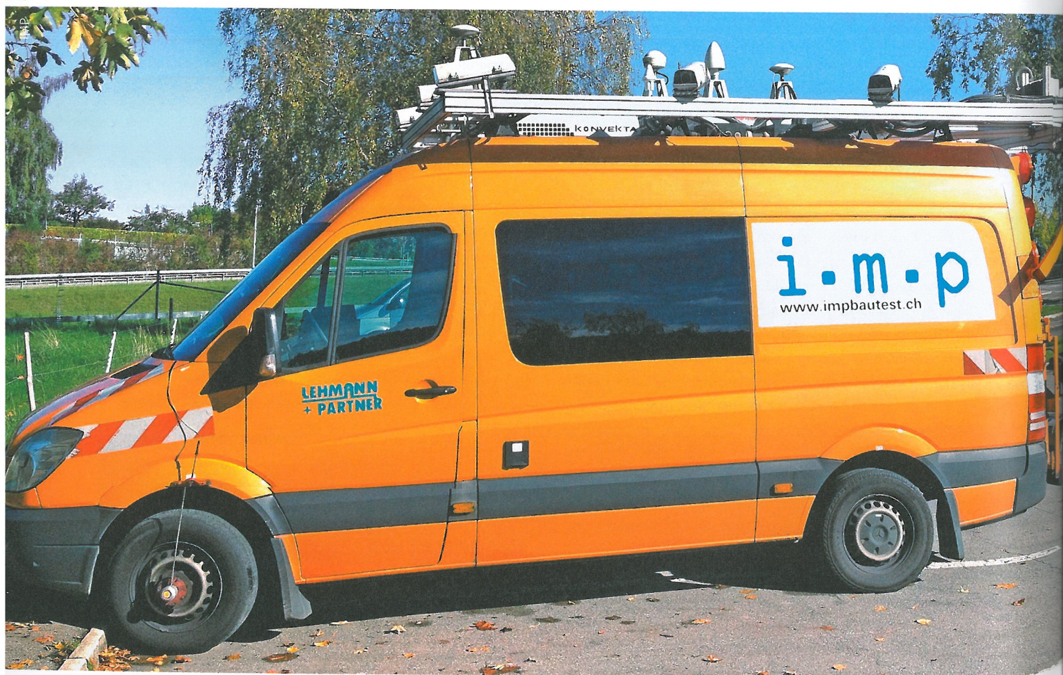
Das Messfahrzeug erfasst Schäden in der Fahrbahn, die Längsebenheit der Strasse, die genaue Position und das Umfeld.
