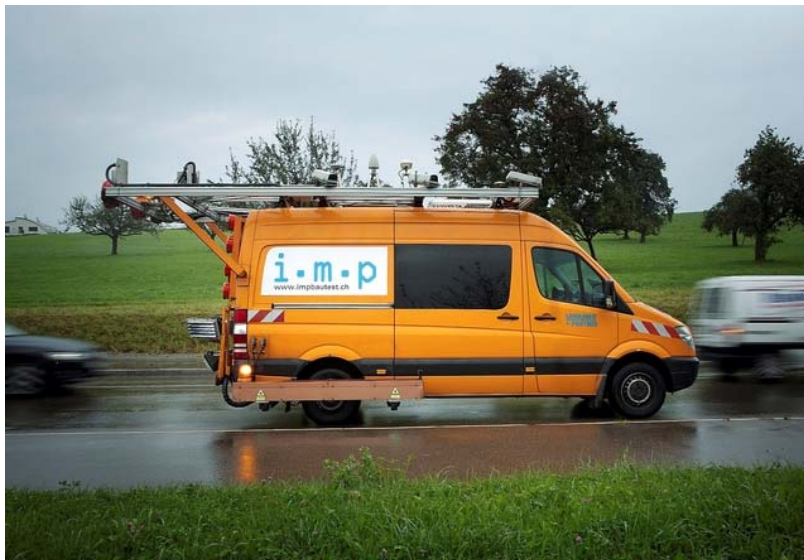
Ein Querprofil alle 3 Zentimeter: Das Vermessungsfahrzeug mit Antennen- und Kamerachristbaum auf dem Dach. Foto: Sabina Bobst
